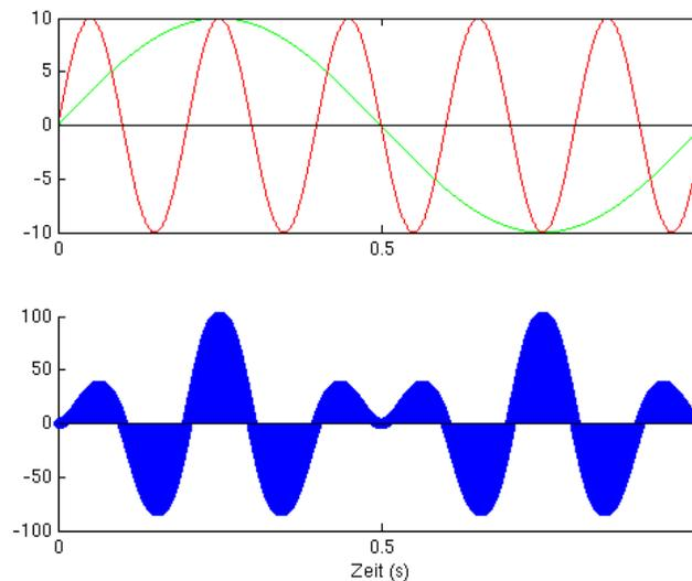
Abbildung 12: Orthogonalität zwischen 2 Sinoidalschwingungen unterschiedlicher Frequenz.
