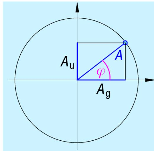
Abbildung 14: Berechnung der Amplitude einer Sinoidalschwingung anhand der Amplituden ihres Sinus-Anteils  $A_u$  und Cosinus-Anteils  $A_g$  mittels Pythagoras.
