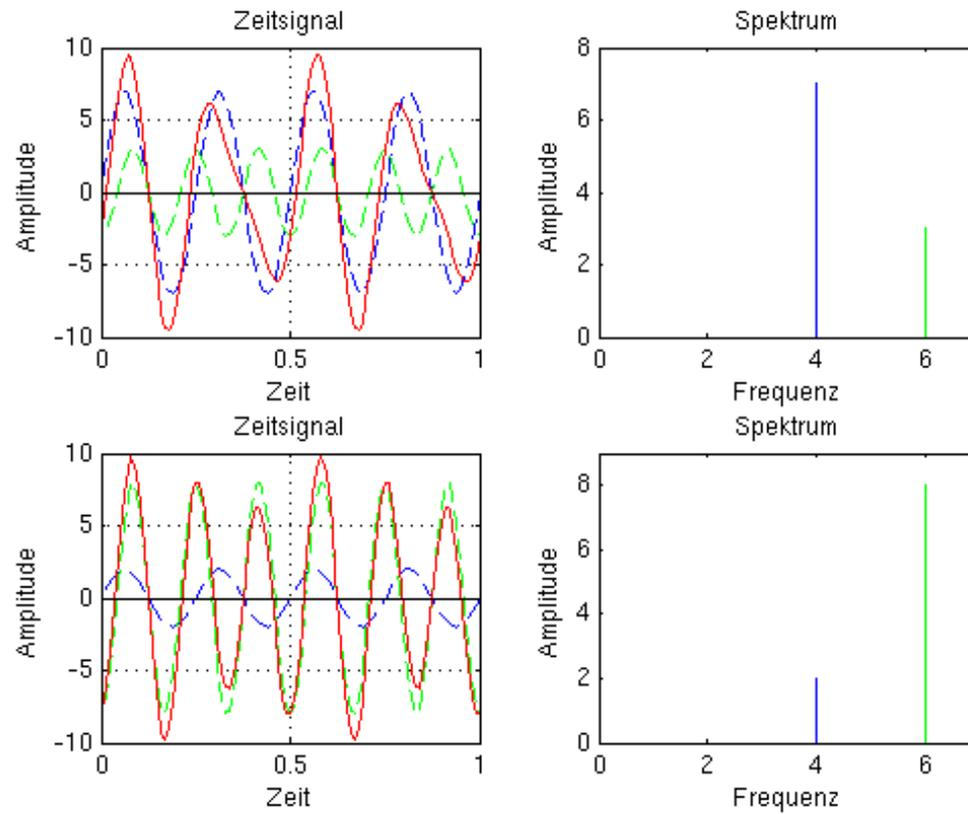
Abbildung 10: *Teilschwingung mit jeweils größerer Amplitude (**oben: blau, unten: grün**) hat stärkeren Einfluss auf das Aussehen der komplexen Schwingung (rot).*
