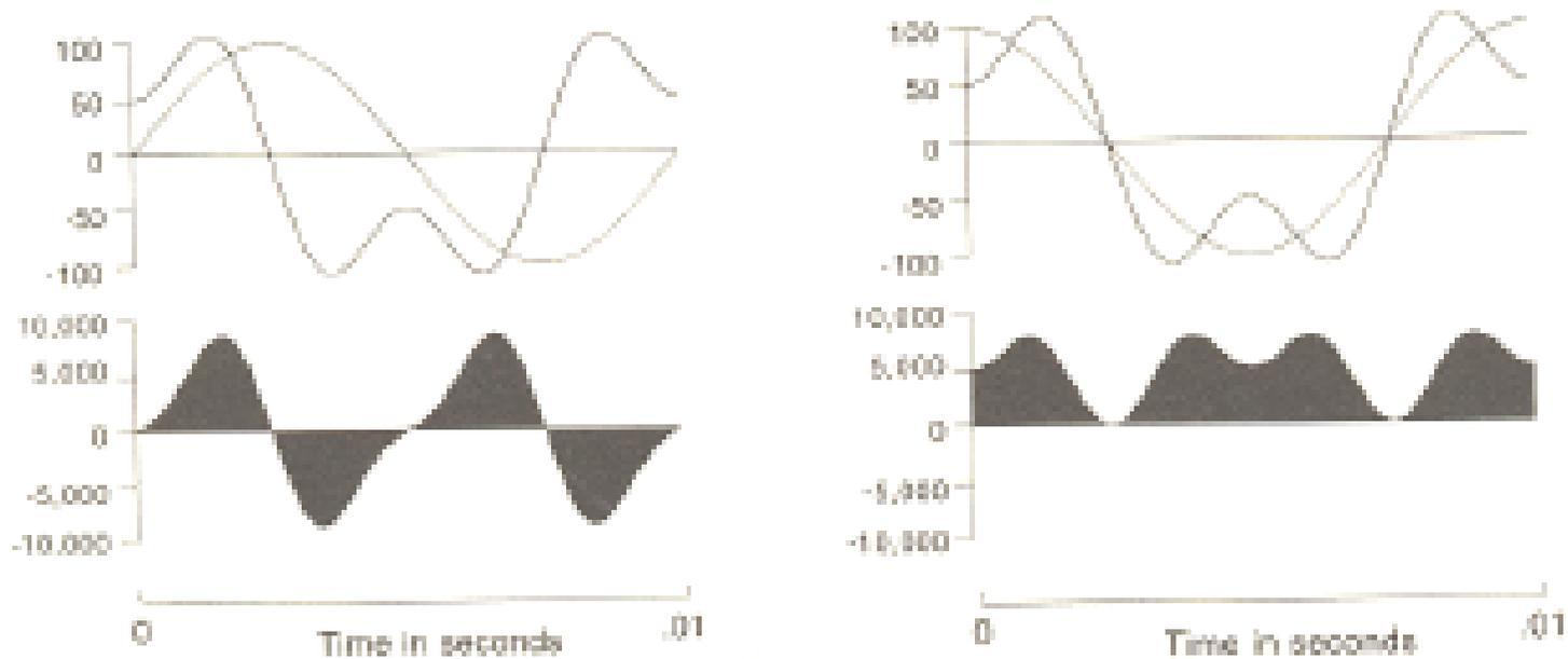
Abbildung 15: **Links:** Sinus-Teilschwingung mit komplexer Schwingung nicht korreliert. Integral der Multiplikation der beiden Schwingungen über eine Periode ist 0. **Rechts:** Cosinus-Teilschwingung mit komplexer Schwingung korreliert. Integral  $> 0$ . (aus Ladefoged: *Elements of Acoustic Phonetics*)
